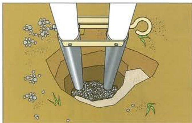
杭セットを穴に入れます。 (塩ビパイプが地上に約5cm~10cm出るようにします。)
